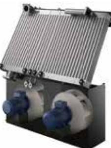
由于冷却器倾斜安置及单通道化，确保冷凝水排除，降低热影响，提高冷却器的耐力。
