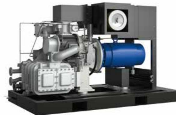
通过降低压损和辅机动力，以及装载IPM电机、或高效电机、离心风扇等高效部件来有效地降低能耗。此外，通过优化冷却器设计，降低排气温度，使后续部件小型化，进一步达到节能的目的。
