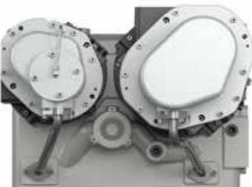
轴端泵内置于齿轮箱。通过高效的主电机驱动，降低电耗。
